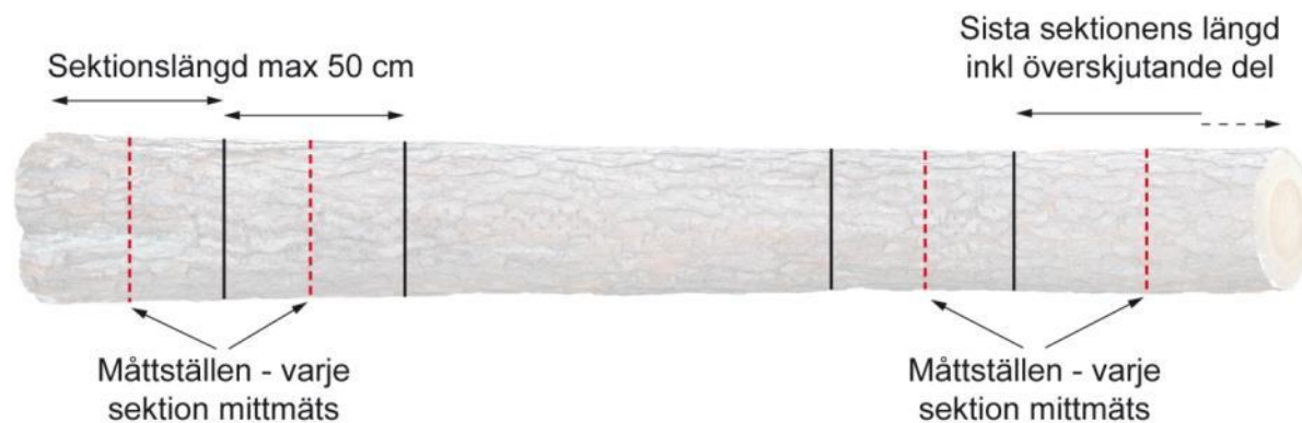
Figur 4. Måttällen för diameter vid sektionmätning.
